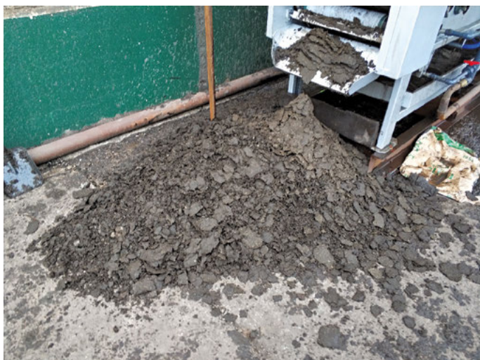
Рис. 5. Выгрузка обезвоженного осадка ТМВ из ленточного фильтр-пресса
